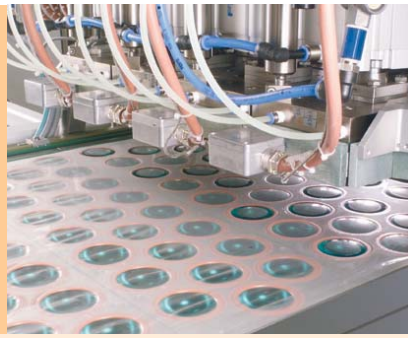
Siegeln von Boden- und Deckfolie mit Einzelsiegelköpfen
