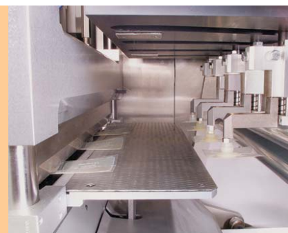
Querschneiden und Übergabe zur Beutelverpackung über Pick-and-Place
