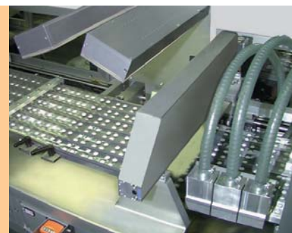
Kamerakontrolle mit anschließender Absaugung von Produktstaub
