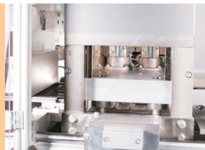
Siegeln von Boden- und Deckelteil
