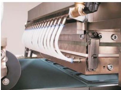
Formen von Bodenteilen für Teströhrchen-Packungen
